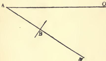
Consiste essenzialmente in due aste  $OA$ ,  $AM$ , articolate in  $A$ , delle quali la prima porta all'estremità  $O$  (polo) una punta che può essere fissata sul piano del disegno, in modo che tutto l'apparecchio possa ruotare liberamente intorno ad  $O$ .
