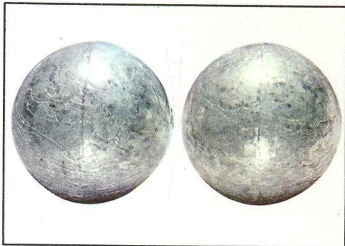
1) **CADMIO GREZZO** - Il cadmio arriva ai laboratori galvanici, dove sarà utilizzato per rivestire altri metalli, sotto forma di sfere di 5-6 cm di diametro. Caratteristica è la colorazione bianca lattescente che esso dona ai metalli che protegge.
