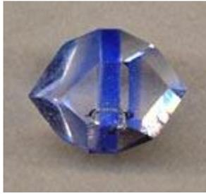
Cristallo interamente creato per sintesi, la lamina di accrescimento bleu, è sicuramente anch'essa sintetica. Russia mm 23
