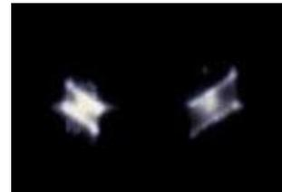
Quarzo. Punti luce della sezione verticale di un geminato del **Brasile** che mostrano l'appartenenza al senso destro o sinistro dei due inserti compenetrati
