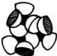
La cella elementare delle fasi quarzo ( $Si_3 O_6$ ), con piccole differenze degli angoli di legame dovute alla temperatura passa dalla fase alfa alla beta. A sinistra è schematizzata una cella senza riportare gli atomi di ossigeno. A destra è riprodotta una cella completa rispettando le dimensioni atomiche. Le sfere nere sono di silicio, le bianche di ossigeno. Si deve ricordare che ogni atomo di silicio è legato a quattro mezzi atomi di ossigeno.
