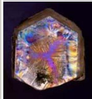
Caso C. Sezione lucidata di cristallo di quarzo, vista in sequenza fra polarizzatori. Al ruotare dell'analizzatore si nota il variare dei colori di una bella stella colorata trigonale, la cui parte interna discordante con l'esterna è anch'essa fittamente geminata del Brasile (tipo ametista ?) .
