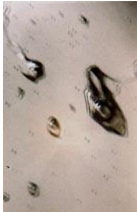
Bolle incluse in un cristallo; fotografate attraverso un romboedro principale. Senza interporre un filtro polarizzatore appaiono sfocate , in realtà sono birifratte , area mm 6.
