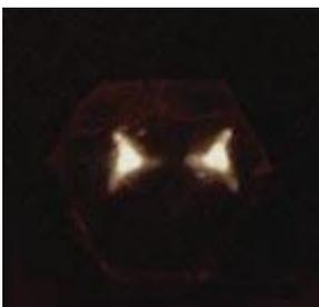
...il dubbio viene risolto con i punti di luce. E' messo in evidenza il geminato del Brasile con le due " stelle " trigonali di senso opposto. Tornadri (SO) .Sezione mm 18
