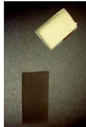
Caso A. Una porzione ruotata di  $45^\circ$  si è illuminata perchè il raggio che l'attraversa viene diviso in due fronti polarizzati ortogonalmente fra di loro e l'analizzatore interposto non li ha estinti.
