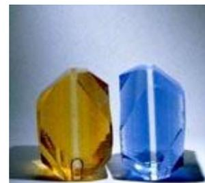
Due cristalli sintetici colorati fatti crescere su lamine trasparenti e incolori tagliate secondo il cosiddetto pinacoide (0001) cioè trasversale all'asse "C". Nella foto è molto evidente il filo metallico di sostegno rimasto incorporato. Russia mm 50.
