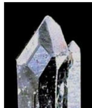
Cristallo di quarzo destro con bipiramide "S" sottoposto a corrosione con acido fluoridrico . mm 20
