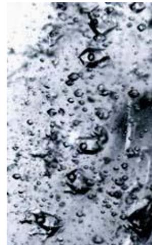
Microfotografia dei vacuoli di una striscia bianca (di tipo 1).Le innumerevoli cavità in questa occasione hanno assunto l'aspetto di cristalli negativi . Normalmente sono di aspetto irregolare . Il senso della banda è verticale . Ghiacciaio del Miage (AO).Area fotografata mm 6,5.ca
