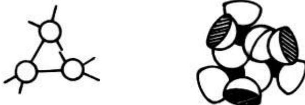
A sinistra è schematizzata una **cella elementare del quarzo** riprodotte i soli atomi di silicio, in pratica è un frammento di spirale trigonale vista dall'alto. A destra è completata annerendo il silicio e aggiungendo anche gli atomi di ossigeno, anzi i mezzi atomi di ossigeno per chiarire l'appartenenza dell'ossigeno agli atomi di silicio disegnati.
