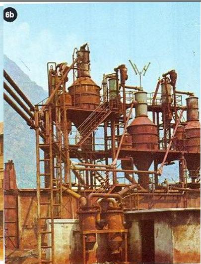
6) SERBATOI DI RACCOLTA DELL'ACIDO SOLFORICO; RECUPERO DELLE CENERI, PURIFICAZIONE DELLE ACQUE –
