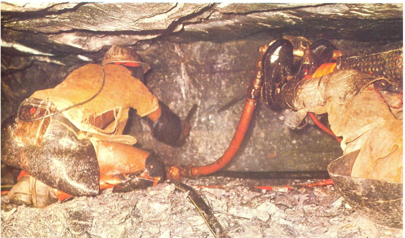
**'ESTRAZIONE DEL QUARZO AURIFERO** – Nelle illustrazioni a e b vediamo dei minatori che stanno perforando col fioretto pneumatico la roccia. Il foro sarà un fornello da mina: allontanati i minatori, la mina esploderà staccando una grande quantità di materiale sotto forma di frammenti minuscoli.
