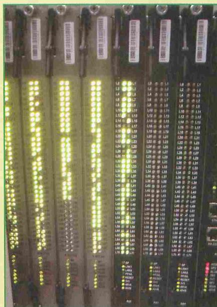
► **Il DSLAM permette di raggruppare più linee con un numero di cavi inferiore. Se è presente non possiamo avere velocità elevate.**
