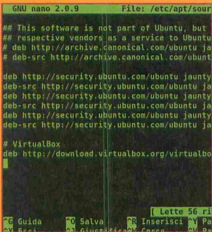
Fig.1. Per installare l'ultima versione di Virtualbox aggiungiamo una riga al file di configurazione dei repository.
