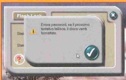
▲ L'avviso è abbastanza chiaro: un altro errore e il disco, cifrato, sparirà nel nulla. L'operazione è svolta dall'hardware della chiavetta, non da Windows.
