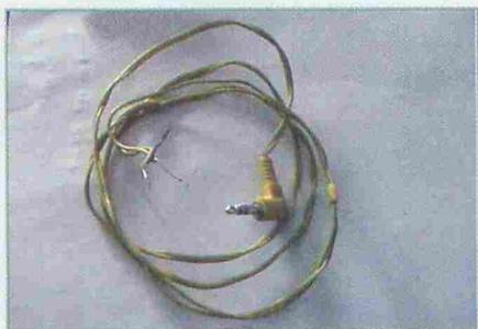
▲ I cavo audio stereo con jack è costituito da tre fili: positivo, negativo e ground.
