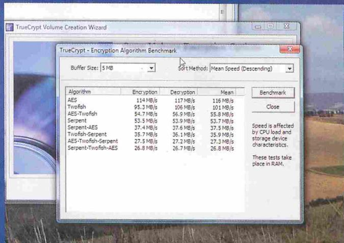
⚠ **La funzione di benchmark permette di controllare i tempi di lettura e scrittura dei dati usando metodi diversi di codifica.**
