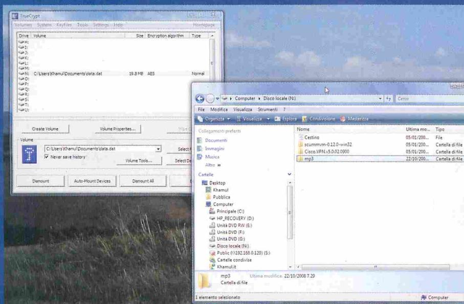
⚠ **Un disco cifrato di TrueCrypt appare al sistema come un normale hard disk ed ha tutte le relative caratteristiche di flessibilità d'uso.**
