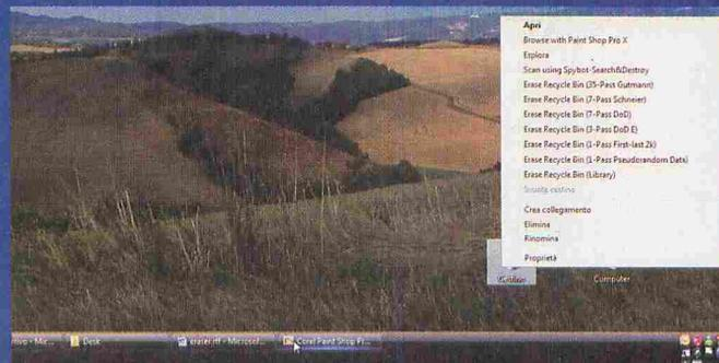
▲ L'integrazione di Eraser con il sistema ci permette di sovrascrivere più volte i file eliminati direttamente durante le operazioni fatte per svuotare il cestino.
