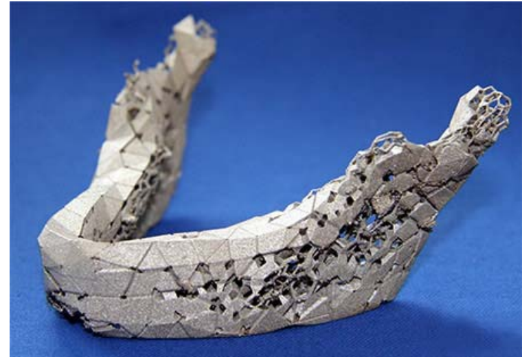
Una mandibola artificiale fatta di titanio e polvere di metalli ottenute con raggi laser
