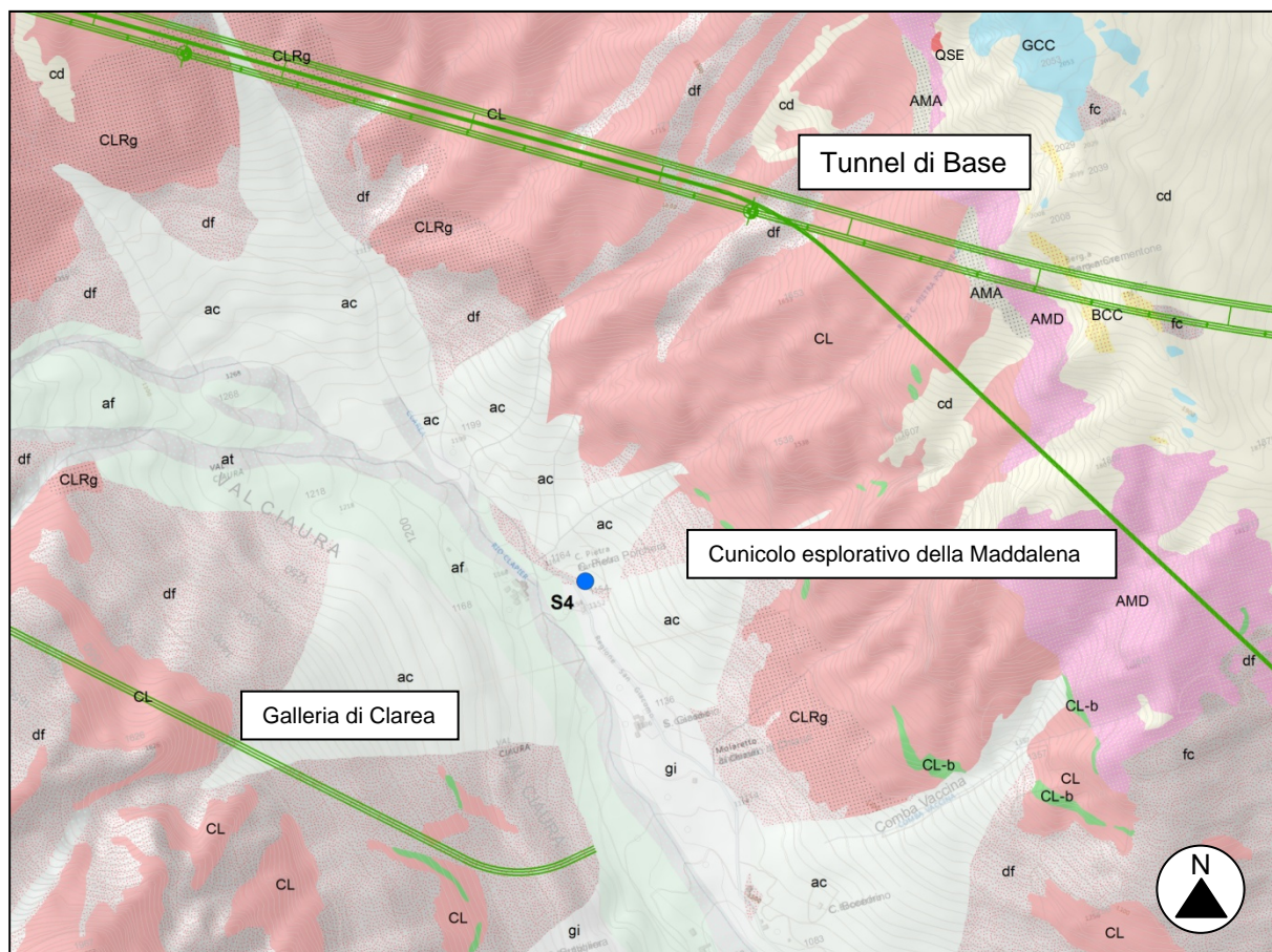
Figura 2 - Ubicazione dei sondaggi (in blu) considerati per la valutazione della concentrazione in amianto negli ammassi rocciosi in Valle Clarea. Zona Piemontese/Unità Puy-Venaus: GCC (scisti carbonatico-filladici); BCC (breccie tettoniche carbonatiche “Carniole” auct.); Complesso d'Ambin: AMD (gneiss albitici passanti a micascisti quarzosi), AMA (micascisti metaconglomeratici a ciottoli di quarzo); QSE (quarziti); Complesso di Clarea: CL (gneiss albitici passanti a micascisti quarzosi); CLRg (micascisti a granto \pm glaucofane), CL-b (metabasiti anfiboliche); depositi quaternari: gi (depositi glaciali indifferenziati), cd (coltre detritico colluviale), df (detrito di falda), fc (accumuli di frane per crollo), ac (depositi di conoide alluvionale o misto), af (depositi alluvionali). Il tracciato è indicato in verde (figura non in scala).
